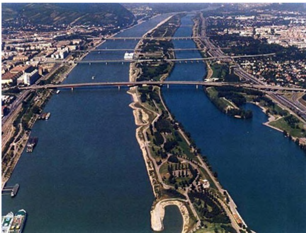
Figura 8. El Danubio a su paso por Viena, a la izquierda el cauce principal, a la derecha el canal aliviadero Neue Donau, y entre ambos la Donauinsel o Isla del Danubio, es una franja artificial de 21,1 km creada para la protección contra inundaciones. Junto a ella corre el Nuevo Danubio (Neue Donau), un canal de control de crecidas que absorbe el exceso de agua del río. Ha surgido una zona con amplio espacio recreativo con playas, bares y naturaleza. [5]
