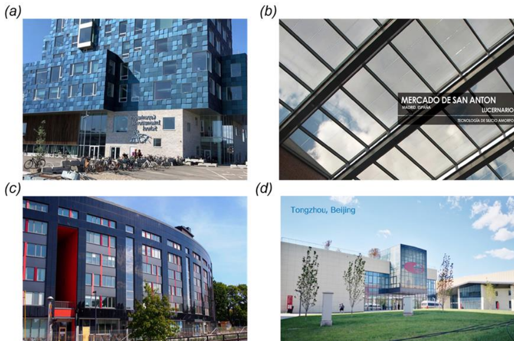
Figura 4. a) Implementación de módulos BIPV coloreados en la Escuela Internacional de Copenhague, b) Lucernario a base de módulos semitransparentes BIPV EN mercado de San Antón en España, c) fachada BIPV Frodeparken en Upsala Suecia, d) Módulos semitransparentes en el teatro nacional en Tongzhou Begin.
