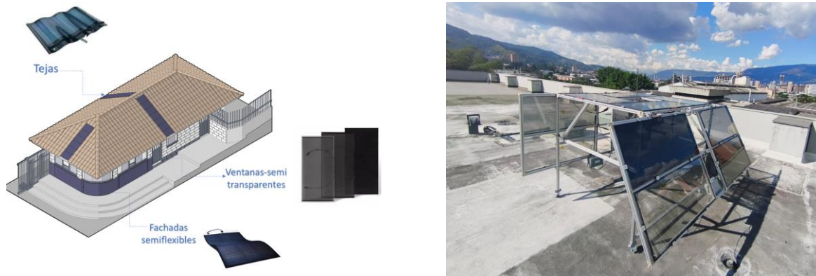
Figura 5. Pilotos de pruebas de tecnologías BIPV en el marco de los proyectos Integra y Perseo de la Universidad de Antioquia. Fuente: Elaboración propia
