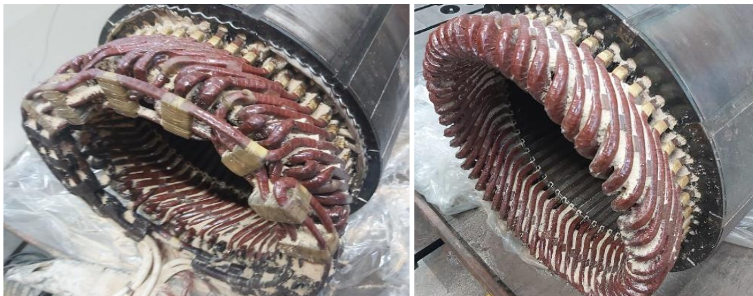
Figura 15 - Muestra contaminada con aserrín fino húmedo (Fuente: WEG).
