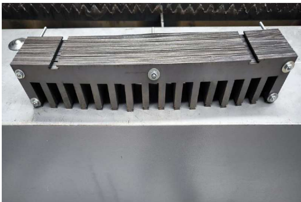
Figura 20. Fabricación de motor lineal
