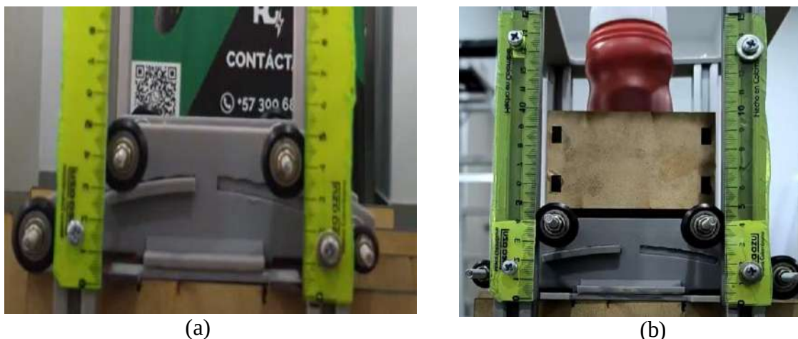
Figura 16. Vagón con diferentes cargas (a) Vagón sin carga y (b) Vagón cargado con 750g
